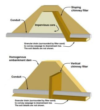
**Figure 12: Conduit Filter Protection**
